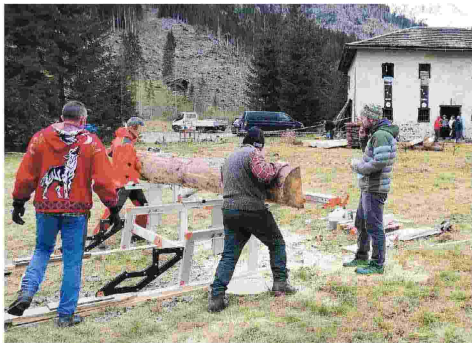
La segheria mobile in azione durante la presentazione del progetto Riambientiamoci che punta a trasformare gli schianti e il legname della Val Visdende in strumenti musicali di qualità. In alto a destra un clavicembalo e nella foto sotto un particolare della attrezzatura semovente che permette di lavorare i tronchi direttamente sul posto per ricavarne tavolame utilizzabile
